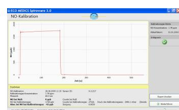
**Anmerkung:** Die NO-Kalibrierung muss jedesmal wiederholt werden, wenn der Probenschlauch gewechselt wird.
