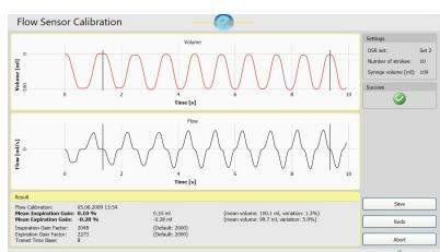
**Anmerkung:** Die Fluss-Kalibrierung muss jedes Mal wiederholt werden, wenn das DSR Set gewechselt wird.
